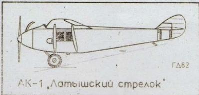
счетов и изготовления чертежей с апреля по ноябрь 1923 года на заводе ГАЗ №5 был построен и самолет. 8 марта 1924 года летчик А. И. Томашевский начал испытывать АК-1. Во время испытаний была достигнута максимальная скорость 147 км/ч, что для того времени было хорошим результатом.
