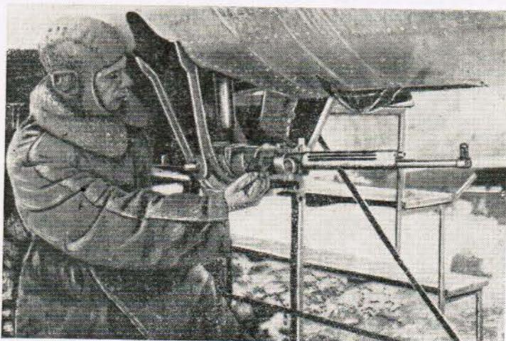
Монтаж пулемета Шкас на люковой установке
